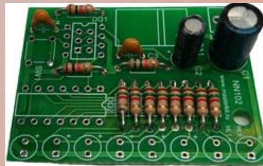
Установка электролитических конденсаторов
